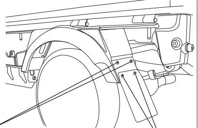
付属丸ボルト、フランジナット使用（純正穴流用）
