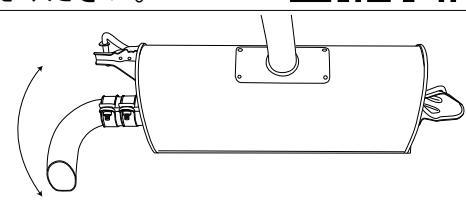
排気口の角度をエアロに干渉しない様に調整し締めをする
