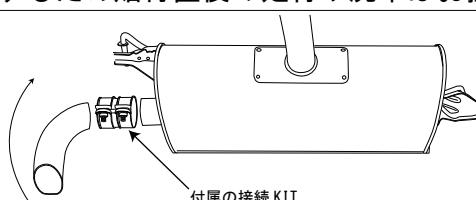
カット部分に付属の接続 KIT を使い排気口を回転調整可能にする
