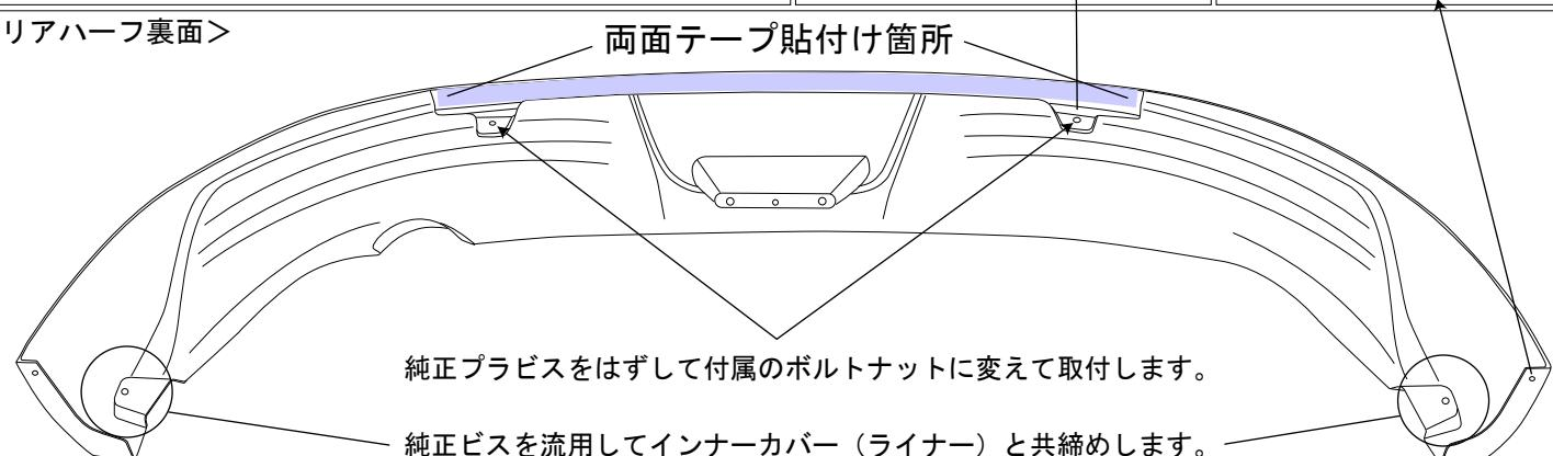
純正プラビスをはずして付属のボルトナットに変えて取付します。
