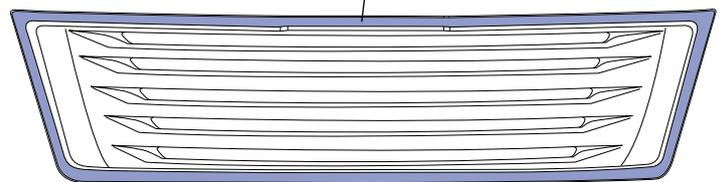
上図を参照にパーツクリーナーなどで脱脂して両面テープを貼り付けて下さい。
