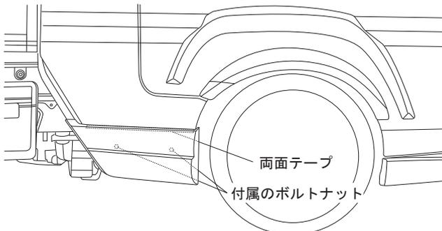
付属のボルトナットで仮止めし位置決め後に両面テープを貼付け最後にボルトナットを本止めします
