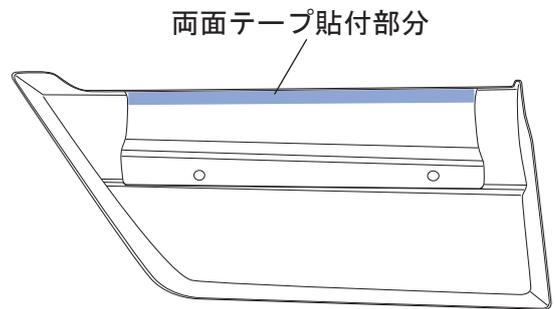
パーツ本体とボディの貼付部分をパーツクリーナー等で脱脂して上図を参照に両面テープを張付けてください
