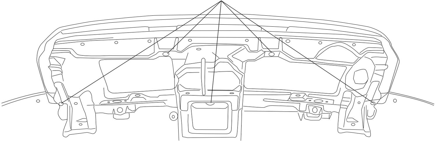
上図を参照に5箇所を付属のボルトナットにて取付して下さい。
