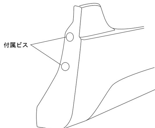
①リア側は 3mm 位のした穴をあけ付属ビスにて取付します。
