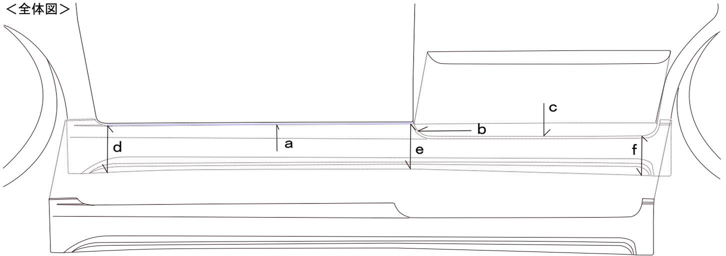
取付位置：(本体) ドア下 a のボディ (フロントドア最下部より約 10mm 下) に合わせて下さい。
