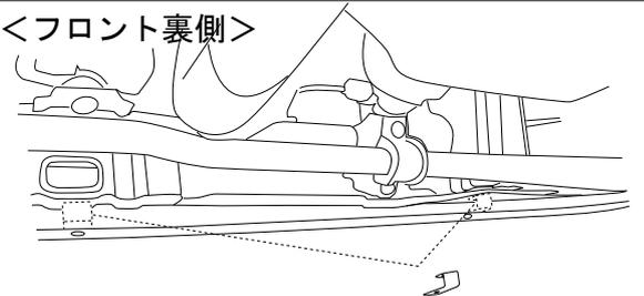
エアロパーツにスティを止めボディ側を位置を確認して付属ボルトナットにて取付して下さい。
