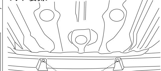
①純正プラビスをはずして付属のボルトナットに変えて取付します。※使用ボルト: 六角型
