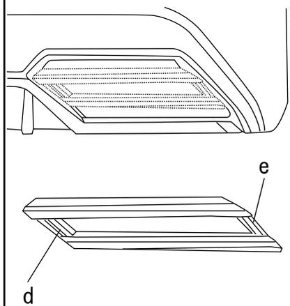
上記図 d・e の各1箇所ずつをエアロバンパーに取り付けます。
