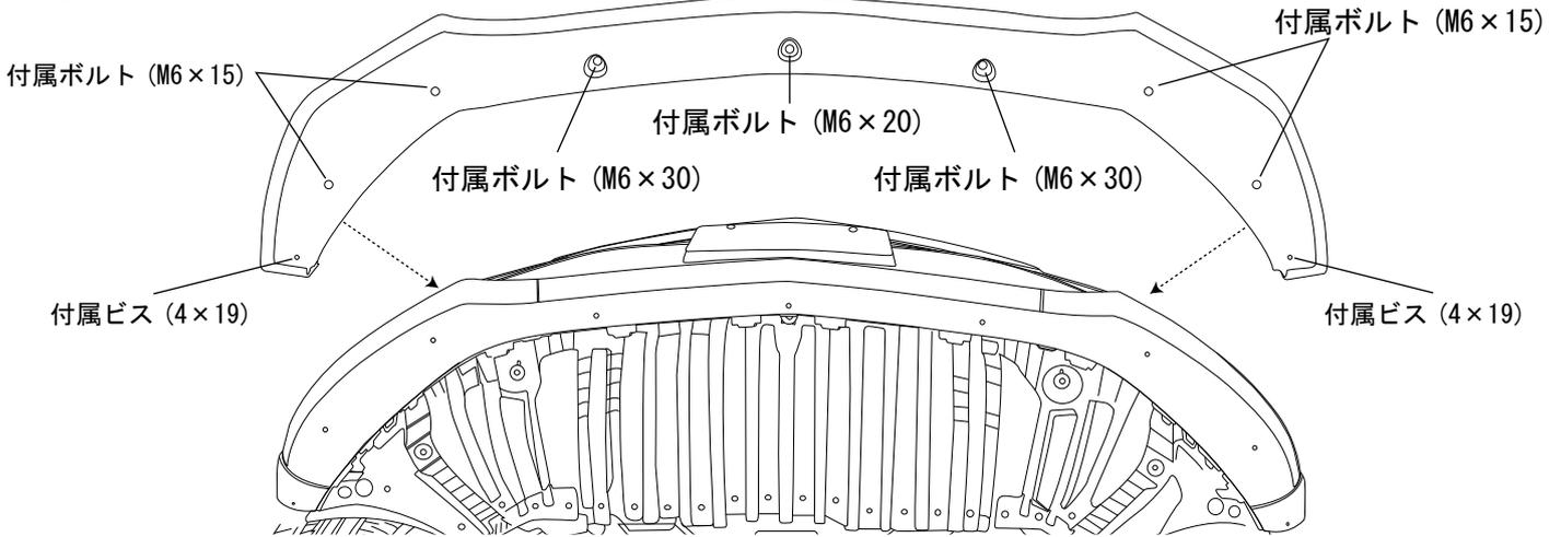
ボルト部分6.5mmビス部分3mm程の穴をあけて付属ボルト・ビスにて取り付けてください。
