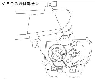
①FOGを横向きにして付属ボルト・ナットにて a部分2箇所を取り付けしてください。b部分 は取付しません。
