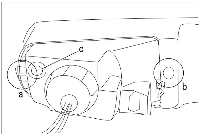
①上記 a 部分を先に入れて b 部分を付属のナットにて取付して下さい。
