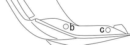
②上記 b・c 部分をフェンダー部分純正スティを外した四角の穴を流用しボディ側から付属のボルト・ワッシャーにて取付けて下さい。
