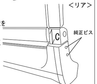
③上記<フロント><リア>のビス止めが終わってからドア下ゴムモール下をしっかり脱脂をして両面テープにて張付けて下さい。
