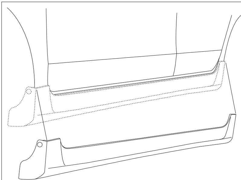
取付位置：純正のサイドステップ（フレーム）に合わせて下さい。
