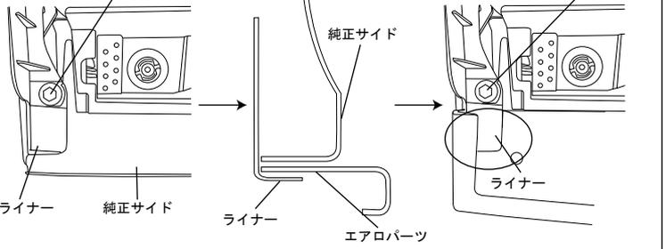
ライナーのボルトを少し緩め純正とライナーの間にエアロパーツを挟み込むように取付します
