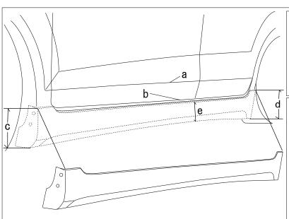
取付位置:(前後)純正プレスライン a に合わせて下さい。 (センター) ドアの下ライン b から約15 mm下に合わせて下さい。
