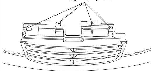
上図を参照に4箇所を純正プラビスにて取付して下さい。
