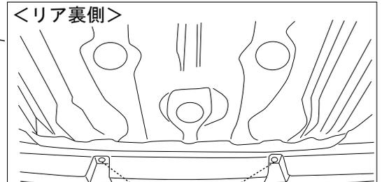
①純正プラビスをはずして付属のボルトナットに変えて取付します。
