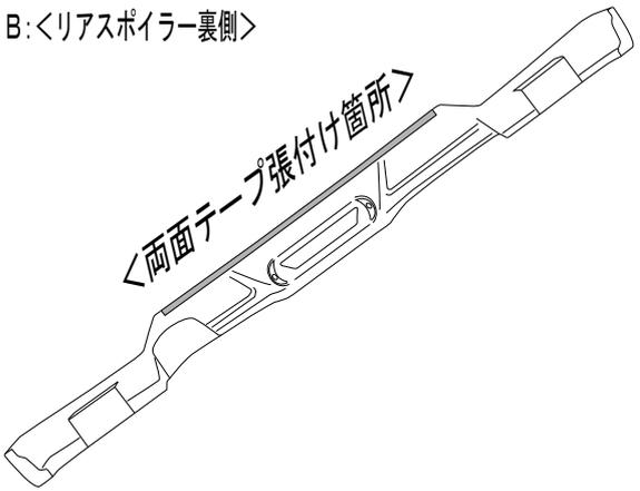
下記図を参照に両面テープを十分に脱脂をして貼り付けて下さい。
