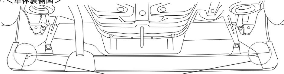
純正の穴を流用して付属のボルトナットにて取付けて下さい。
