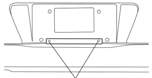
エアロパーツの位置を確認してエアロパーツの穴に合わせ下穴3mm程の穴を空け付属のビスにて取付して下さい。
