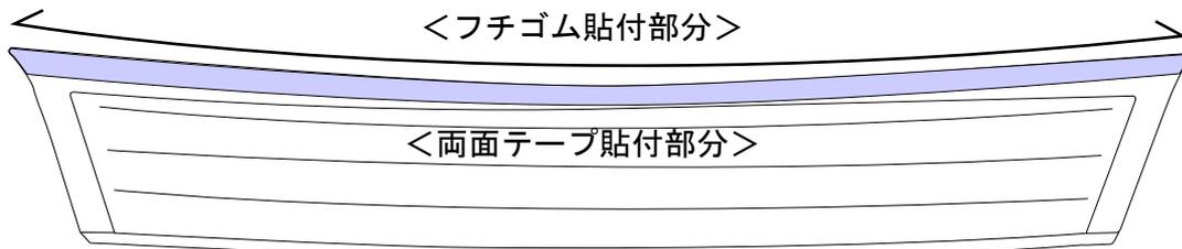
上図を参照にパーツクリーナーなどで脱脂して両面テープを貼り付けて下さい。
