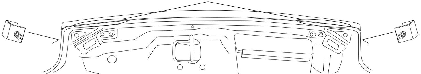
付属のコの字スティを使って両サイドを取付けて下さい。(脱落防止の為使用することをお勧めいたします。)
